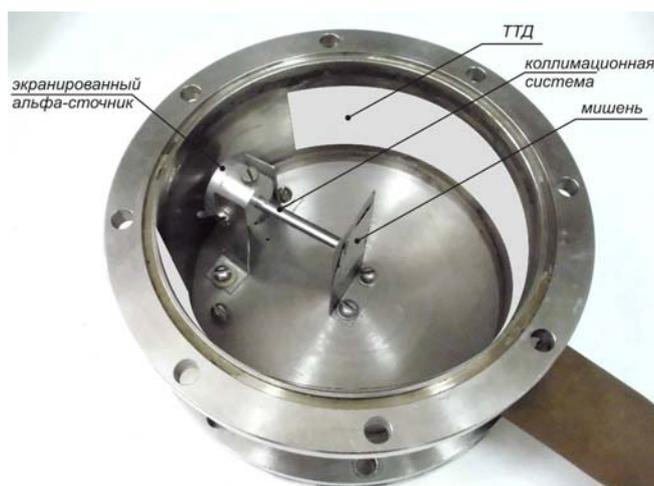
Рис.4. Камера рассеяния для измерения углового распределения упругорассеянных альфа-частиц с энергией 5,5 МэВ на ядре 27-Al
