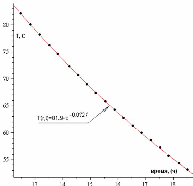
Рис. 2. Падение температуры в точке шара находящейся на расстоянии 10 см от центра (внешний радиус шара R=18 см).
