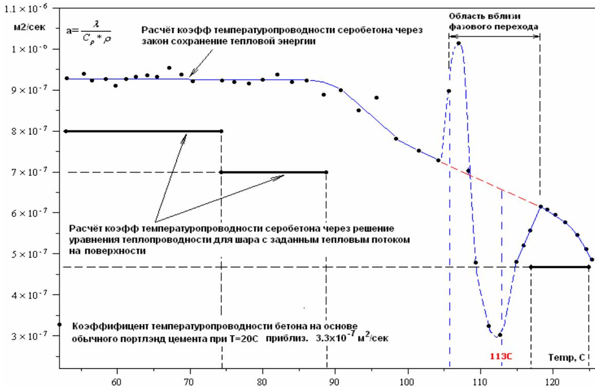
Рис.1. Оценка коэффициента температуропроводности серобетона через (1) закон сохранения тепловой энергии и (2) решение уравнения теплопроводности для шара с известным тепловым потоком на поверхности
