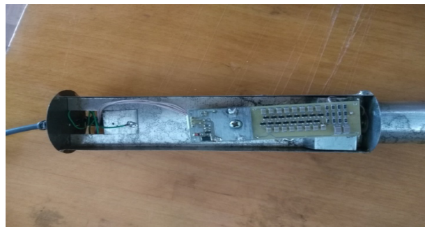
Рисунок 3 – Основные узлы подключения и передача сигналов с разрабатываемой аппаратуры для автоматического измерения потоков нейтронов
