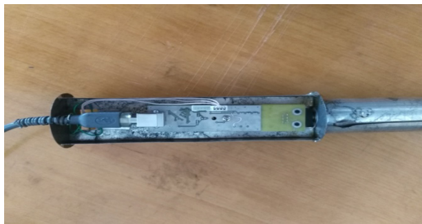
Рисунок 3 – Основные узлы подключения и передача сигналов с разрабатываемой аппаратуры для автоматического измерения потоков нейтронов
