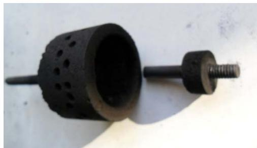
Рис. 1. Схема реактора с генератором ферроцена и фотография полого катода с анодом
