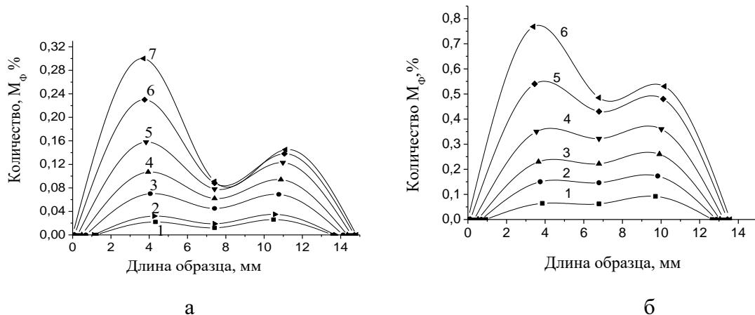
Рисунок 10 Кривые распределения мартенситной  $\alpha'$ -фазы в процессе деформации образца стали 12Х18Н10Т по длине его рабочей части. а – необлученный; б – облученный нейтронами флюенсом  $2 \cdot 10^{20} \text{ н/см}^2$ .
