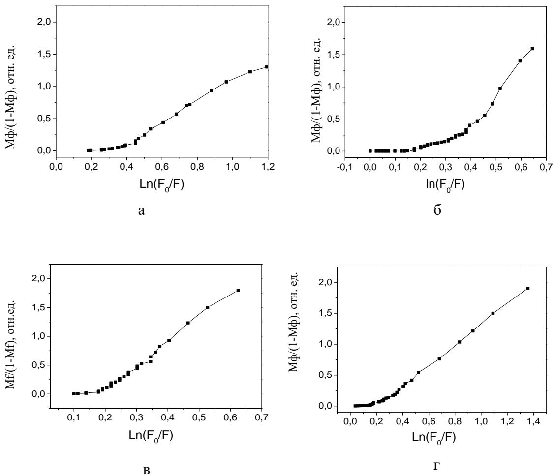
Рисунок 11 Изменение относительного содержания мартенситной  $\alpha'$ -фазы в зависимости от истинной деформации ( $e = \ln F_0/F$ , где  $F$  – площадь сечения рабочей части образца) в области шейки образца стали 12Х18Н10Т. а–необлученный; б–облученный нейтронами ( $2 \cdot 10^{18} \text{ н/см}^2$ ); в–облученный нейтронами ( $5 \cdot 10^{18} \text{ н/см}^2$ ); г–облученный нейтронами ( $2 \cdot 10^{20} \text{ н/см}^2$ ).
