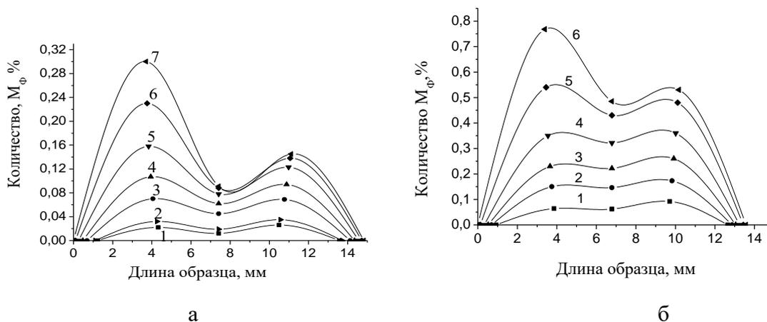
Рисунок 10 Кривые распределения мартенситной  $\alpha'$ -фазы в процессе деформации образца стали 12Х18Н10Т по длине его рабочей части. а – необлученный; б-облученный нейтронами флюенсом 2·10<sup>20</sup> н/см<sup>2</sup>.
