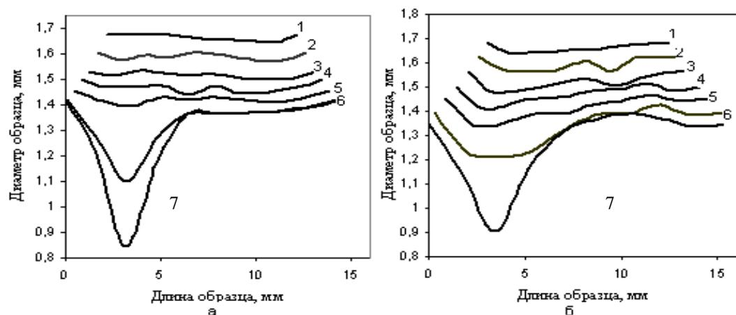
Рисунок 6. Изменение диаметра образца стали 12Х18Н10Т в процессе пластической деформации (по данным оптического экстензометра) а – необлученный; б - облученный нейтронами флюенсом  $2 \cdot 10^{20}$  н/см<sup>2</sup>. Цифры у кривых означают моменты растяжения, и соответствуют точкам на кривых приведенных на рисунке 4.
