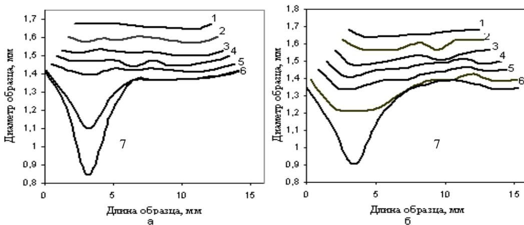
Рисунок 6. Изменение диаметра образца стали 12X18H10T в процессе пластической деформации (по данным оптического экстензометра) а – необлученный; б - облученный нейтронами флюенсом  $2 \cdot 10^{20}$  н/см<sup>2</sup>. Цифры у кривых означают моменты растяжения, и соответствуют точкам на кривых приведенных на рисунке 4.
