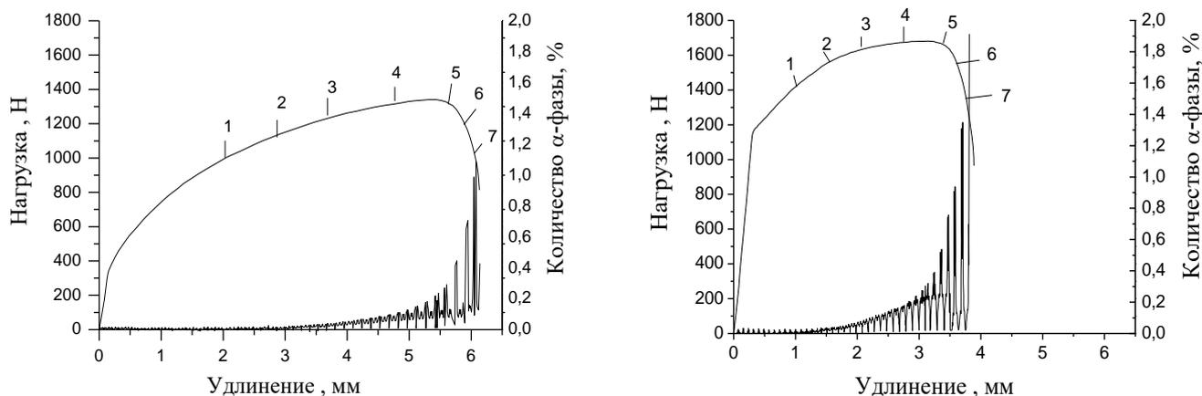
Рисунок 4. Диаграммы растяжения и кривые накопления мартенситной  $\alpha'$ -фазы для необлученного (а) и облученного (б) нейтронами ( $2 \cdot 10^{20}$  н/см<sup>2</sup>) образцов стали 12X18H10T ( $T_{исп}=20$  °С).
