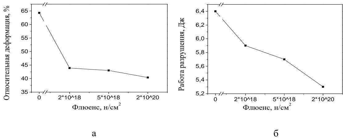
ских характеристик стали 12Х18Н10Т в зависимости от флюенса нейтронного облучения. а—пластичность; б—работа, затраченная на разрушение образца.
