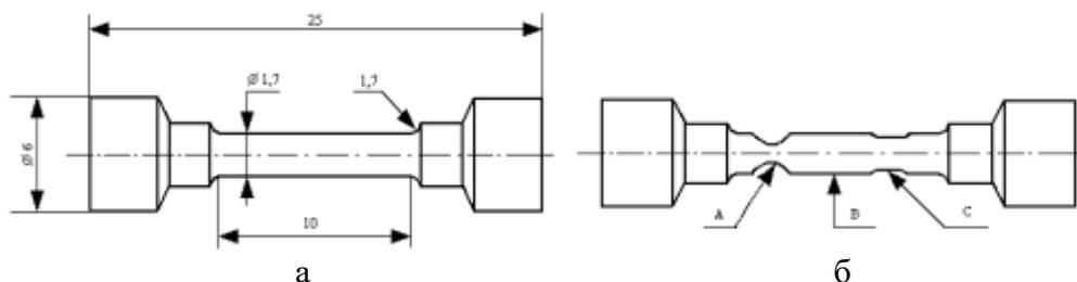
Рисунок 1 а) Размеры и форма исследуемых цилиндрических образцов из стали 12Х18Н10Т до растяжения; б) Схема образца после растяжения. Указаны области (точки) А, В и С, в которых измерялся диаметр и ферромагнитная фаза.
