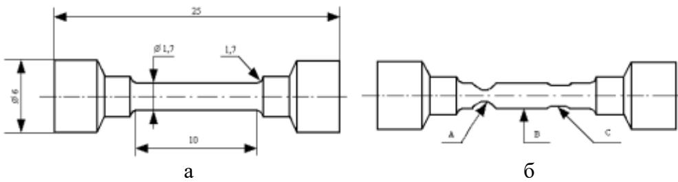
Рисунок 1 а) Размеры и форма исследуемых цилиндрических образцов из стали 12Х18Н10Т до растяжения; б) Схема образца после растяжения. Указаны области (точки) А, В и С, в которых измерялся диаметр и ферромагнитная фаза.
