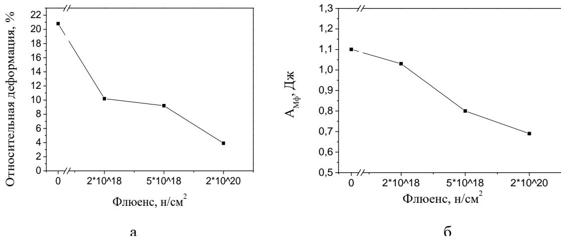
Рисунок 9. Влияние флюенса нейтронов на критические значения деформации образования  $\alpha$ -фазы (а) и работу, затраченную на растяжение до момента образования  $\alpha$ -фазы (б).
