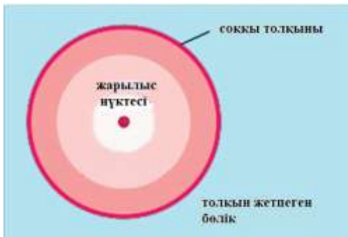
2-сурет. Сфералық соққы толқынының жарылыс болған нүктеден радиалды таралуы
