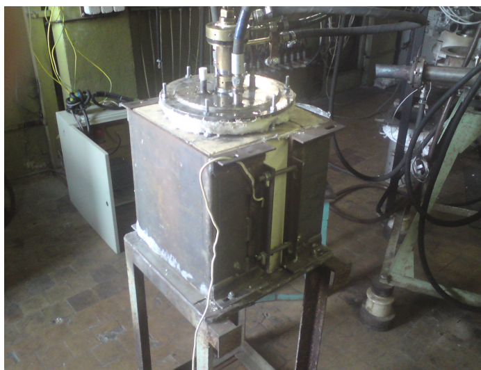
1 – электродуговой плазмотрон, 2 – крышка плавильной камеры печи, 3 – плавильная камера, 4 – огнеупорная футеровка, 5 – устройство для выхода отходящих газов, G_v – ввод охлаждающей воды, G_r – выход охлаждающей воды
