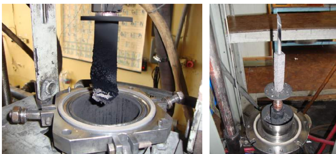
Рисунок 3 – Депозитный материал, образованный на катоде (слева) и израсходованный графитовый материал на аноде (справа)
