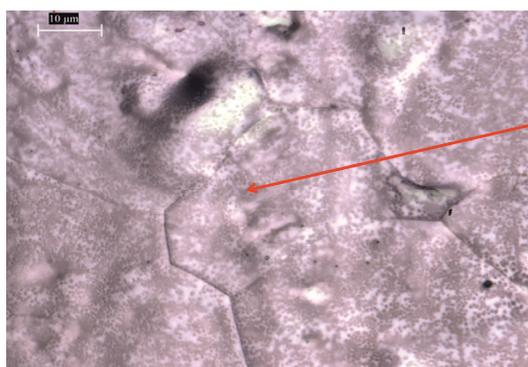
**Рисунок 5** – Типичные оптические микрофотографии образцов, полученных методом CVD (Leica DM 6000M, ННЛОТ, КазНУ).
