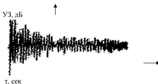
2-сурет – БА-3 (нқж) болатының екпіннен дыбыс импульсінің үдету осциллограммасы
