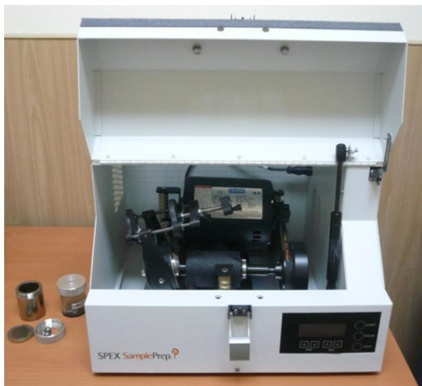
Рисунок 1 – Высокоэнергетическая шаровая мельница SPEX SamplePre 8000M
