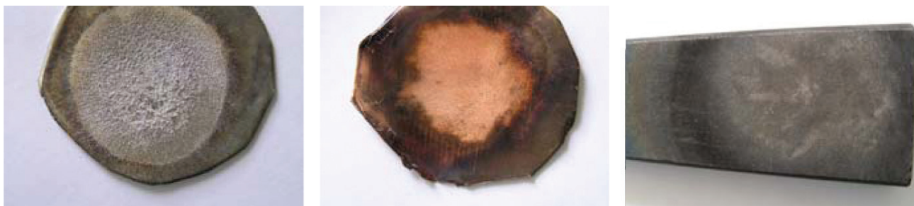
Рисунок 5 – Диаметр пятна облучения для алюминия, меди и графита
