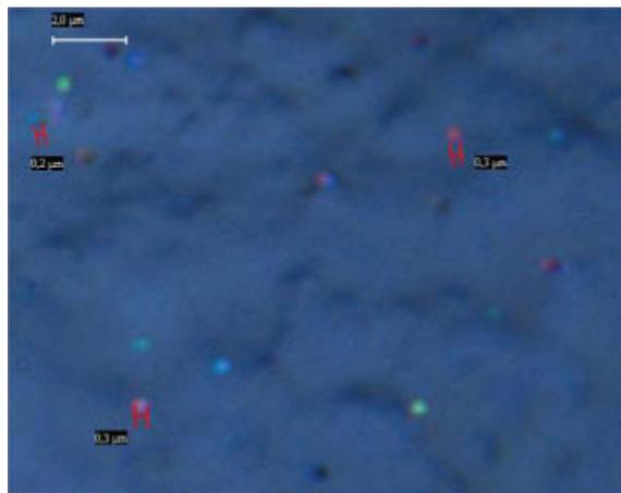
**Рисунок 1** – Данные оптической микроскопии для лиофильно высушенного образца гидрогелевой повязки, содержание нитрата серебра в ИРС – 50 ppm
