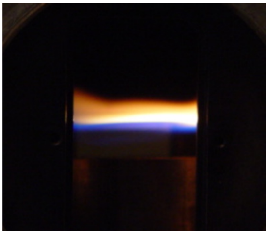
Рисунок 2 – Фотография пропан-кислородного пламени на встречных струях и расположения зон по вертикали
