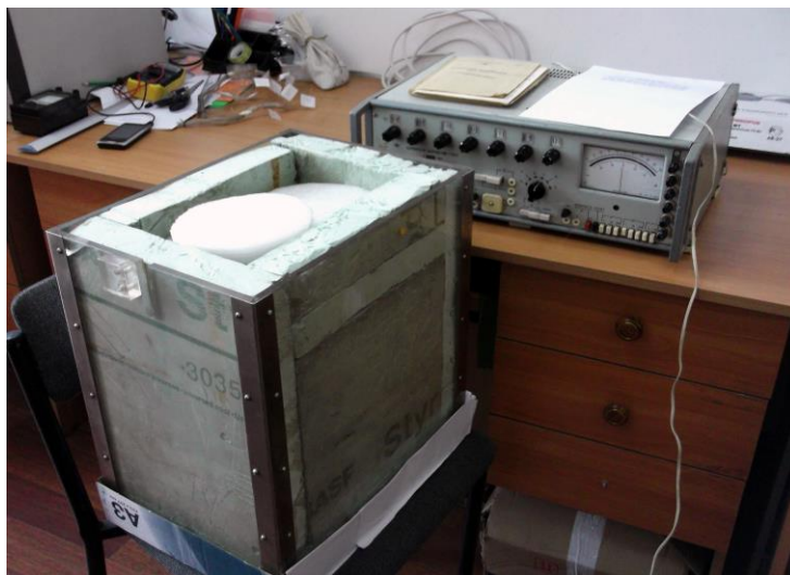
Рисунок 3- Физическая установка – спэйскалориметра
