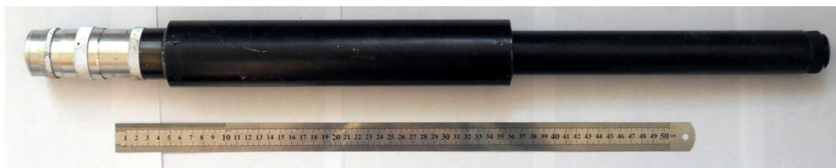
**Рисунок 8** – Фотография действующего макета зрительной трубы с переменным фокусным расстоянием
