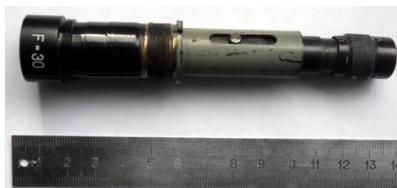
**Рисунок 11** – Фотография действующего макета миниатюрной зрительной трубы
