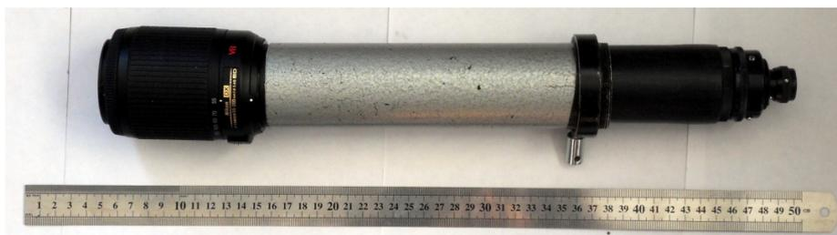
**Рисунок 10** – Фотография действующего макета зрительной трубы с трансфокатором
