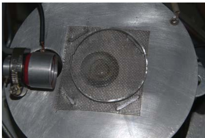
Рисунок 4 – нижний электрод с «электроловушкой»
