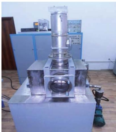
Рисунок 1 – Вакуумная импульсная дуговая установка
