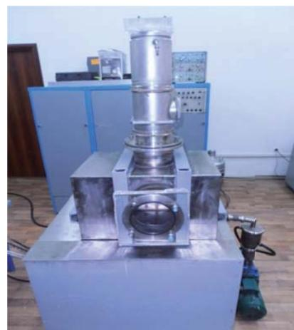
Рисунок 1 – Вакуумная импульсная дуговая установка
