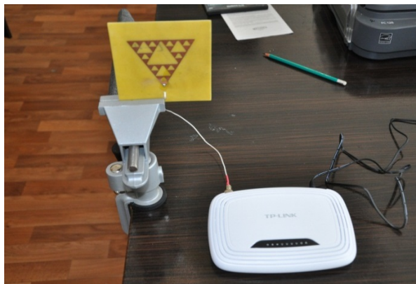
4-сурет – Фракталдық антеннаны Wi-Fi антенна ретінде зерттеу процесі
