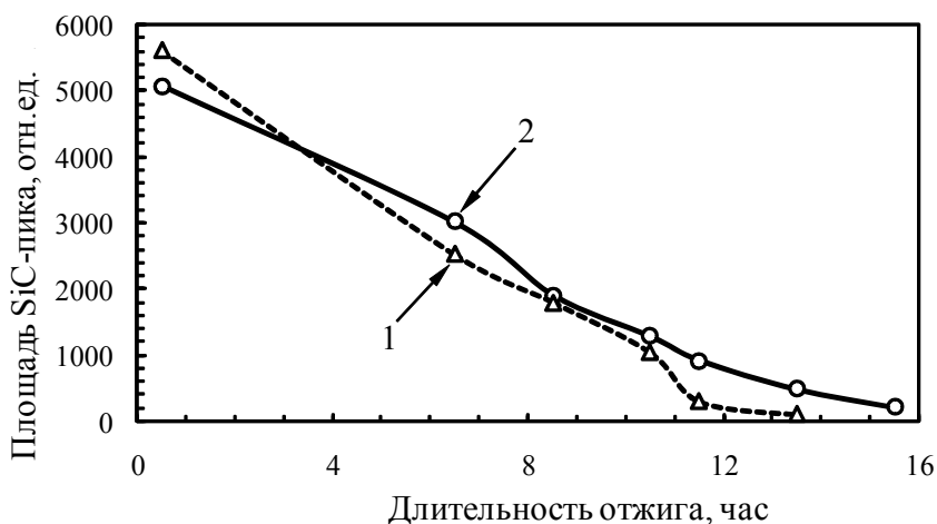
Рисунок 6 – Площадь пика TO-фононов SiC в спектрах ИК-пропускания в зависимости от длительности отжига при температуре 1200^\circ\text{C} для слоев \text{SiC}_{0.7} (угол падения ИК-лучей на образец – 73^\circ от нормали): 1 - ориентация подложки Si (111); 2 - ориентация подложки Si (100)
