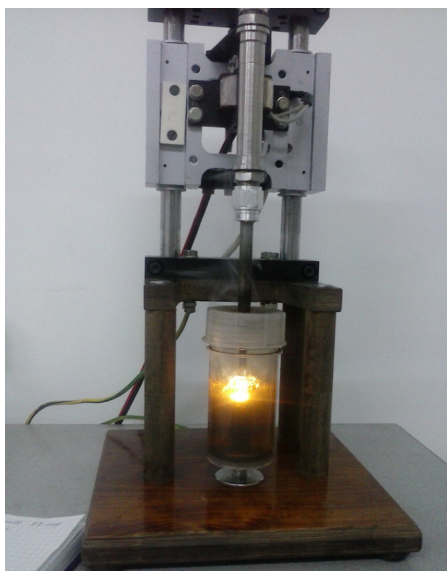
Рисунок 3 – Синтез наноструктурированных материалов в среде раствора хлорид железа/спирт/дистиллированная вода
