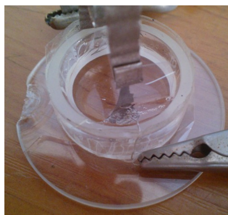
Рисунок 6 – Установка для гидрогенизации малослойного графена большого размера на стекле (КазНУ им. аль – Фараби, ННЛОТ)
