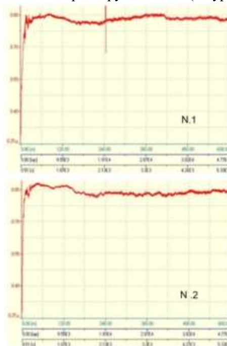
3-сурет. Үйкеліс коэффициентінің (TiZrNbYAl)N қаптамаларының қашықтыққа, цикл санына және эксперимент уақытына тәуелділігі
