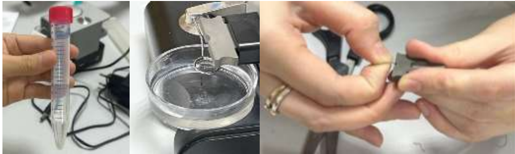
Рисунок 2 – Изготовление зонда с помощью электрохимического травления
